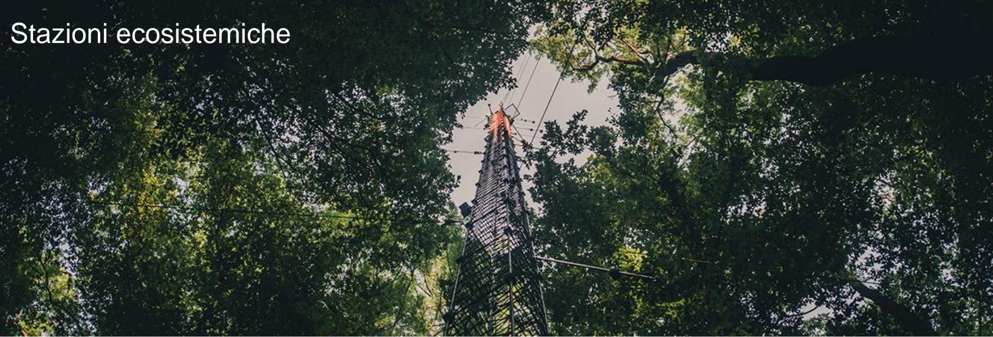
La rete di stazioni ICOS Ecosystem è un'installazione di strumentazione, solitamente su una torre, che misura i flussi di gas serra, nonché componenti viventi e non viventi e driver responsabili dello scambio di gas serra, acqua ed energia tra ecosistemi e atmosfera.
